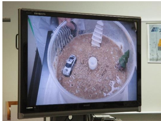
写真9 液状化現象実験
