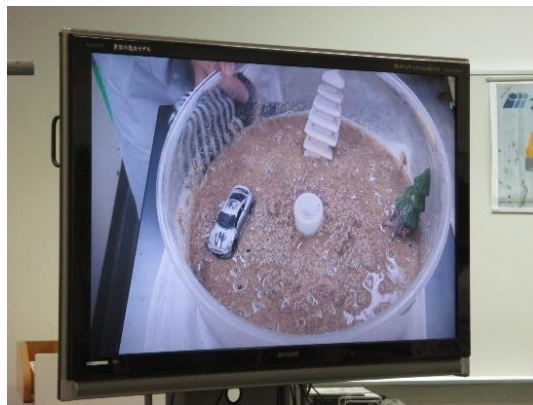
写真9 液状化現象実験
